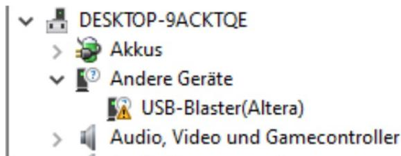
Sie müssen auch den Treiber für Ihren USB Blaster installieren. Der Treiber wird bei der Installation des Programmiergeräts mitgeliefert und befindet sich im Unterverzeichnis "Treiber".
